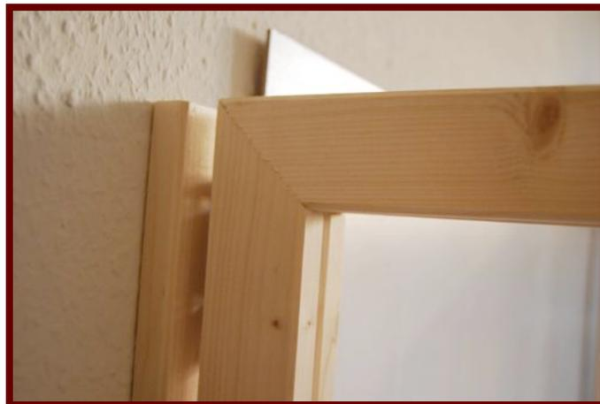
Da ich nicht wollte, dass das Hobbyglas einfach an die Leisten geschraubt wird, sondern „eingelassen“ aussieht, haben wir auf Grund mangelnden Werkzeuges zur Verarbeitung einer Nut einfach einen doppelten Rahmen gebaut und das Glas in der Mitte „eingelassen“. Dies hat den Vorteil, dass dadurch auch die „Standfläche“ der Elemente über 4 cm beträgt, was sie nicht so wackelig sein lässt.
